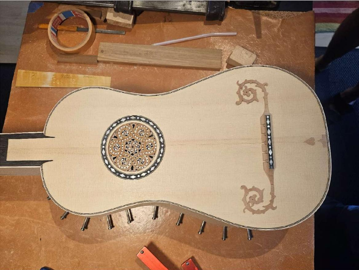
Die Lackierung erfolgte mit alkoholbasierten Lacken aus dem Geigenbau
