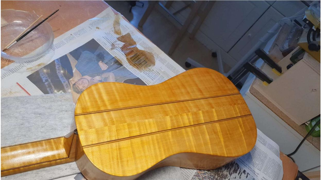
Zwischenschliff nach jeder neuen Lackschicht
