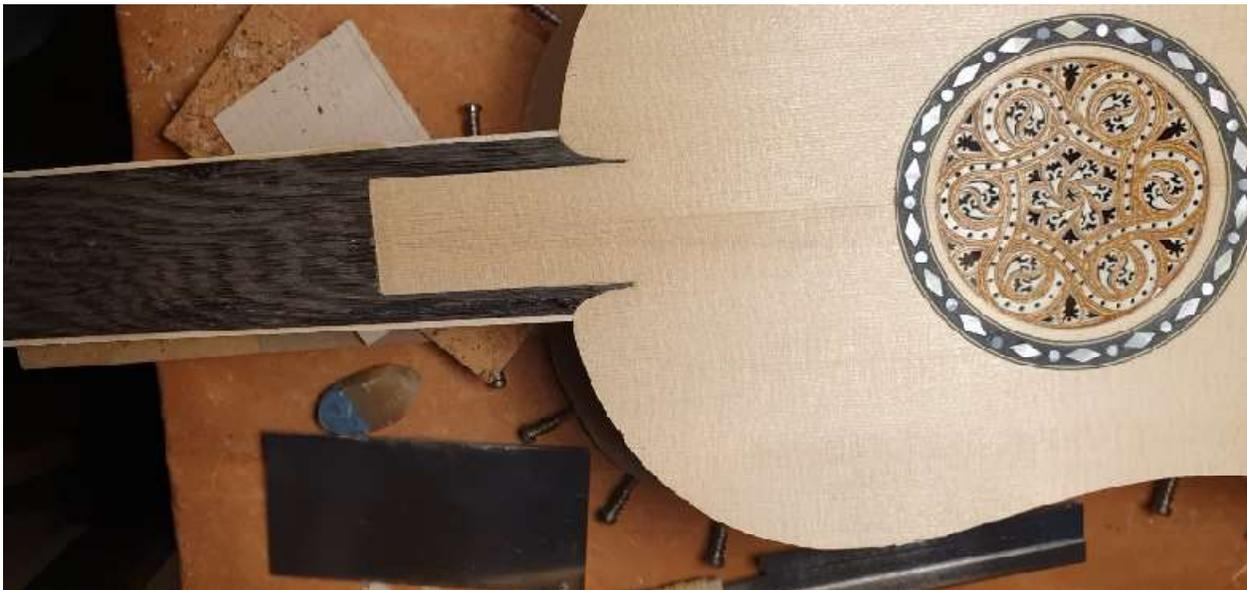
Arbeiten für das Anbringen des Bindings um die Decke. Einmal mehr ist hier Vorsicht geboten, viel Material gibt es da nicht und jeder Fehler würde in einer Katastrophe enden. Das Binding selbst wurde über die Form feucht und mittels Hitze vorgebogen
