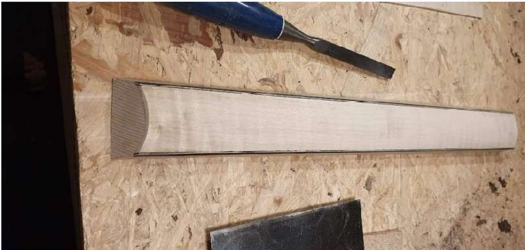
Der Halsfuß wurde gebaut, die Befestigung des Halses erfolgte später mittels einer Schraube. Stradivari hat bei seinen Gitarren mehrere Nägel (neben der Verleimung) verwendet, aus Gründen der Stabilität machte hier eine Schraube etwas mehr Sinn.
