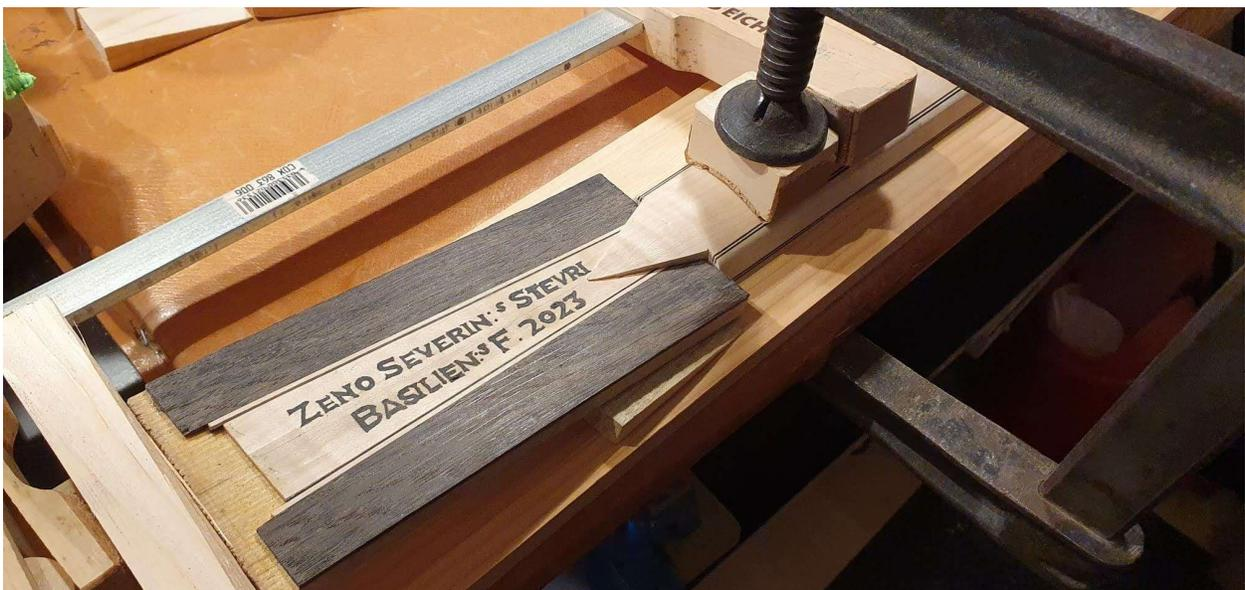
Biegen der Zargen an die Innenform. Zur Fixierung dieser wird jeweils an der schmalsten Stelle ein kleiner Holzdübel verwendet. Nach dem Entfernen der Form wird dieser Plan abgesägt und ist somit nur noch dezent wahrnehmbar.
