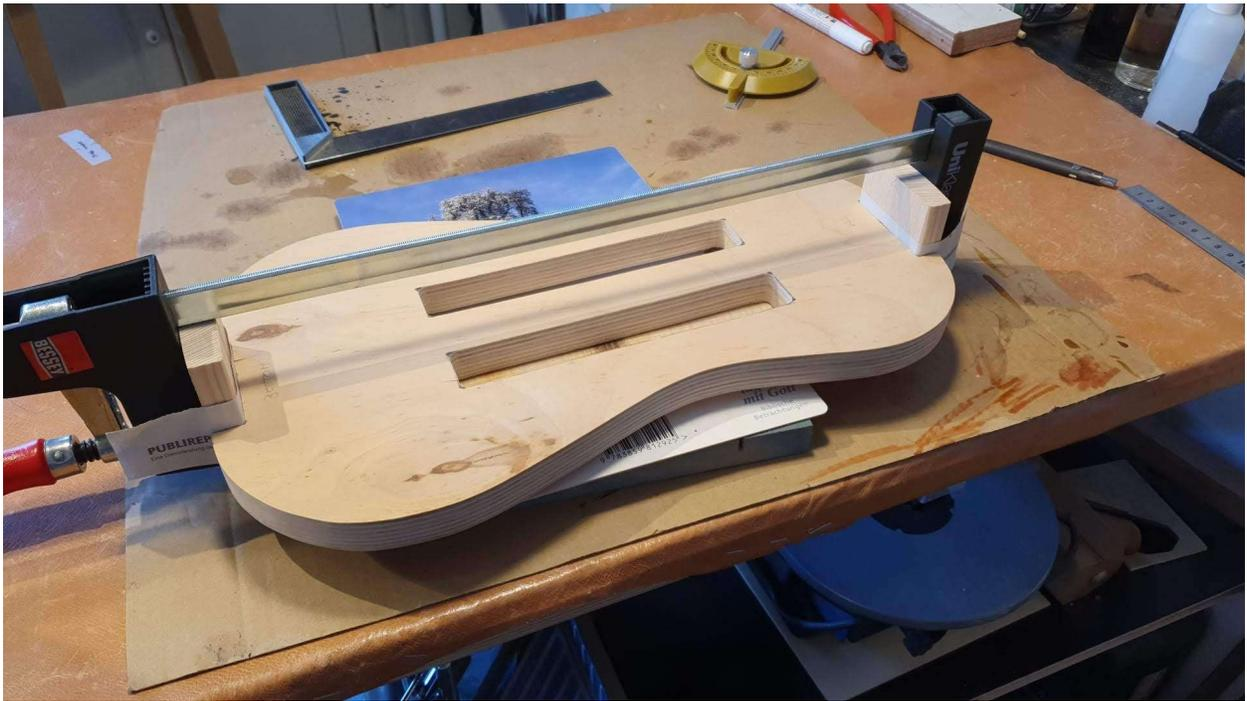
Parallel dazu wurde der Rohling für den Hals aus Fichte gefertigt, in Form gebracht und mit Ahornfurnier belegt (die Zierstreifen stammen aus dem Geigenbau). Halsfuss und die Schwalbenschwanz Verbindung der Kopfplatte wurden erstellt wie auch die Kopfplatte selbst in Sandwichbauweise (Mooreichenfurnier über Ahorn).
